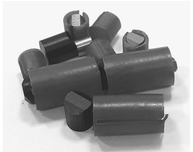
Рис. 2. Імітатори осколків F5 та F3 (відповідно до STANAG 2920 ) та контейнери для їх розгону в каналі ствола
