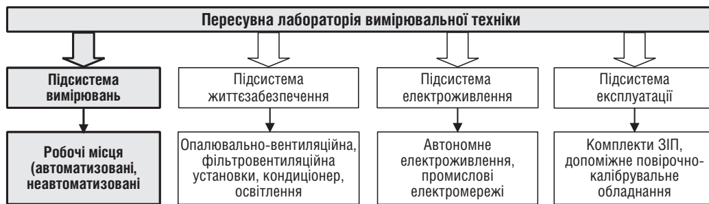
Рис. 1. Структурна схема пересувної лабораторії вимірювальної техніки
