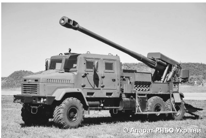
Рис. 3. Самохідна гаубиця «Богдана» (калібр 155 мм)
