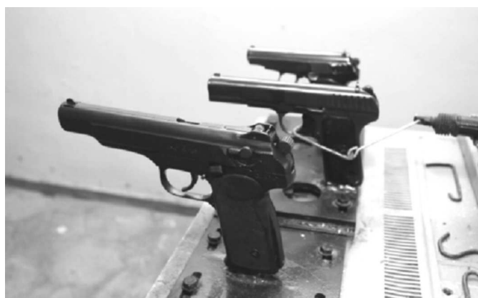
Рис. 7. Пристрій для кріплення пістолетів
