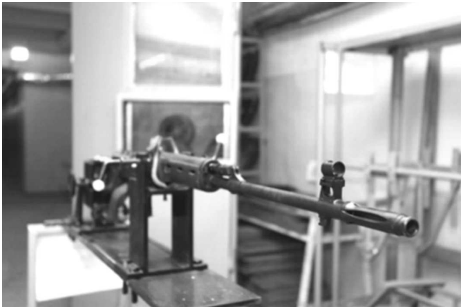
Рис. 8. Пристрій для кріплення автоматів і гвинтівків
