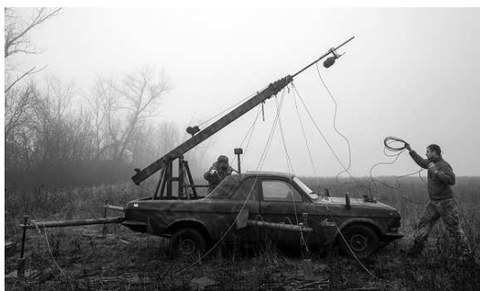
Рис. 1. Телескопічна вежа з дистанційною камерою на радянському автомобілі для спостереження та коригування вогню під Харковом (фото The Wall Street Journal)
